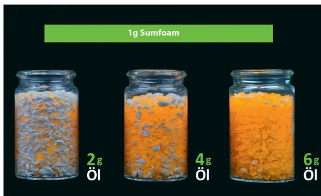
**Bild 4.** Sumfoam kann die bis zu sechsfache Menge seines Gewichts an Öl aufnehmen
